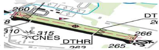
Câble de treuillage au centre de la piste planeurs, utilisable aux deux QFU (2 témoins lumineux) (Source de l'image : SIA)
