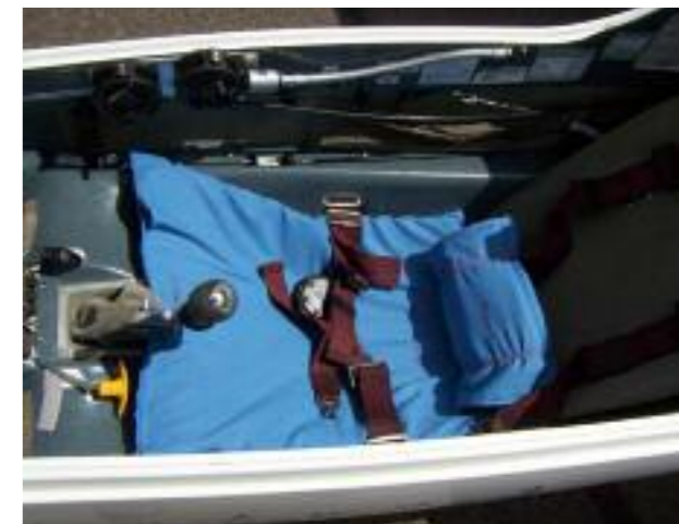
■ Cette photo montre un coussin de mousse absorbante d'énergie et, sur la droite, un coussin-support lombaire personnel.
